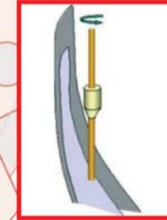
**AUTOMATIC ELECTRODE FEEDING SPINDLE**
